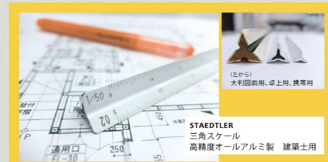
建築図面の中に、寸法は当然記載されています。が、知りたい部分がない場合どうするか。そんな時登場するのが【三角スケール（通称サンスケ）】です。横から見ると三角柱のカタチで、三面の両側に計6種類の異なる縮尺の目盛りがついた縮尺定規。図面の縮尺に合わせて定規を当たれば、面倒な計算なく、実際の長さが読みとれる便利な品です。愛用しているのはアルミ製。
